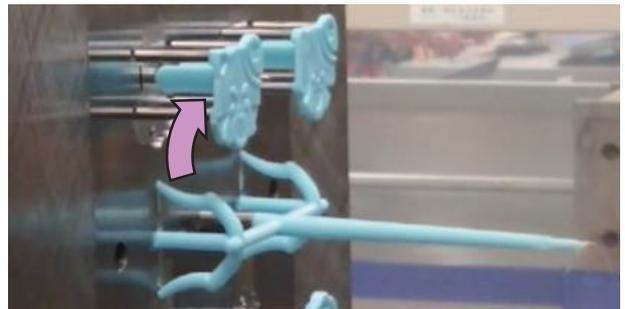
図21 ゲートが離型する直前②(抜き方向左右)
