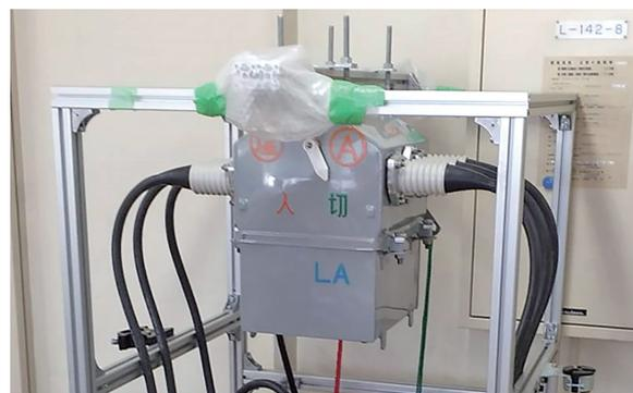
図2 柱上気中負荷開閉器の実習装置
