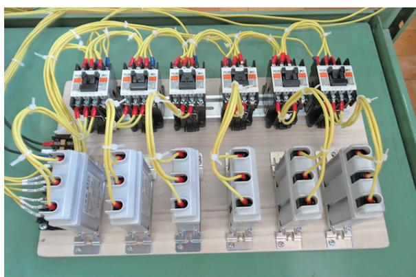
図7 APFCにより操作されるコンデンサ
