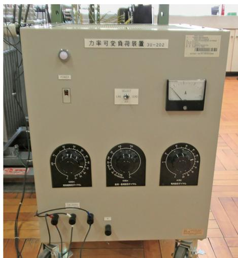
図6 力率可変負荷装置
