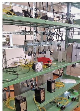
図3 真空遮断器と継電器類、計器類の様子
