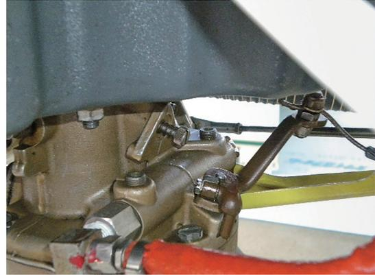
アイドリング時に混合比を濃くする理由は、文献[2]に次の記載がある。「低速運転時にはバルブ・オーバーラップが高出力状態に適するように設定されているため、燃焼室内に排気が残って混合気を薄め、またエンジン温度も低く燃料気化が不十分となるので混合比を濃くする必要がある。」
