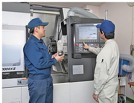
図6 ターニングセンタによるNC加工
