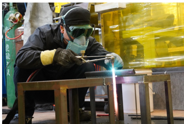
図4 選手作業風景（ガス切断）
