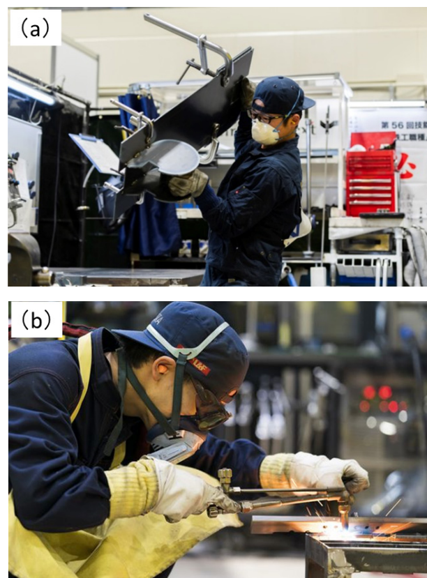
図4 選手作業風景 (a) 鋼材のハンドリング (2018), (b) ガス切断 (2019)
