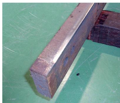
図12 摩耗したブレード
