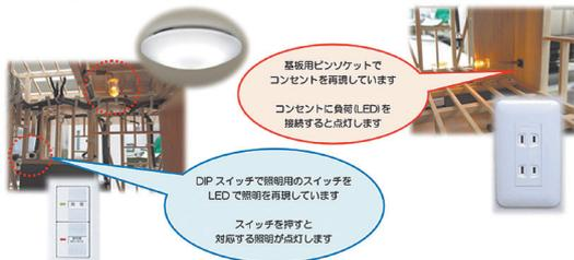
基板用ピンソケットでコンセントを再現しています
