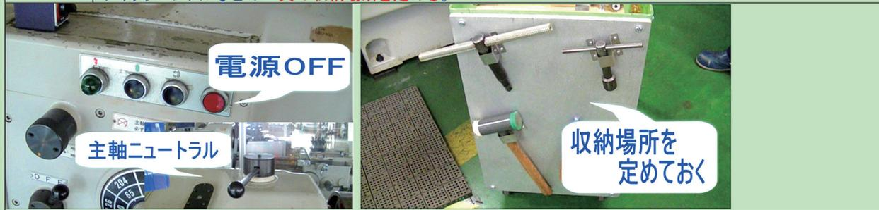
図 チャックハンドルを収納し忘れ主軸を回転したため飛来し、別の訓練生に接触、打撲
