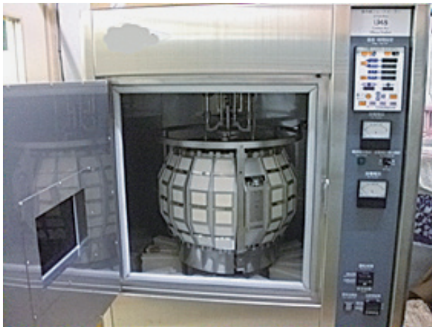
図20 紫外線試験機
