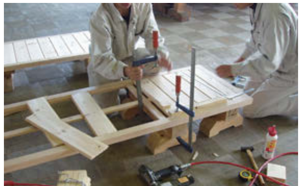
図8 鏡板の取付け作業
