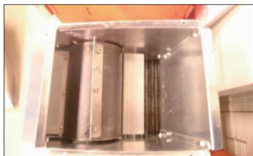
図17 改良した破碎機構
