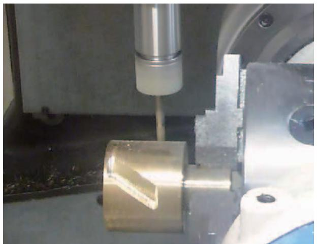
図13 5軸マシニングセンタによる様子
