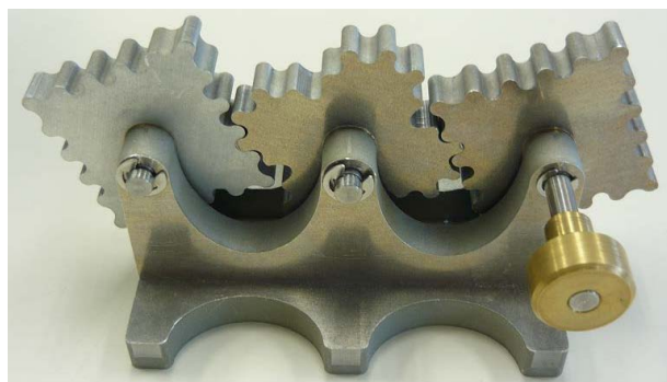
図10 創成法による四角形歯車の製作例
