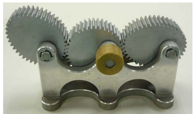
図1 非円形歯車の工作例 (総形法によるインポリュート歯車)
