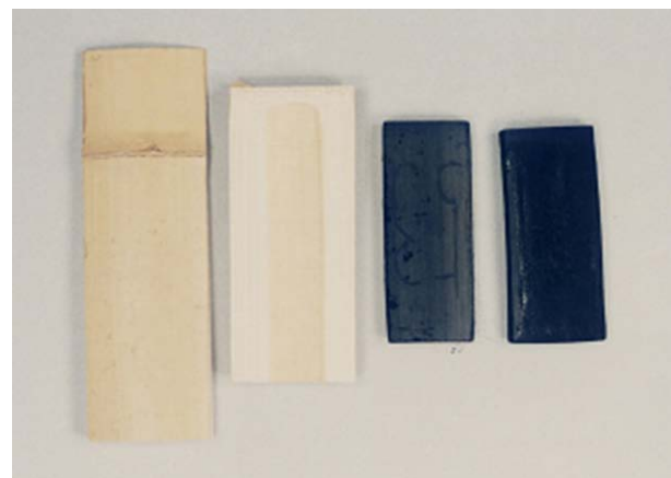
図13 竹材の多孔質炭素材料 20) (左から、竹材、フェノール樹脂含浸材、焼成材2枚)
