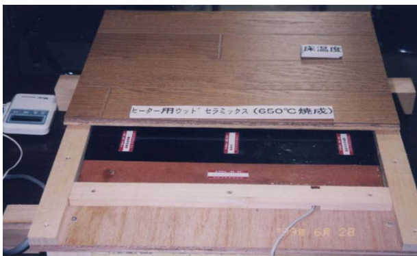
図11 床暖房用の発熱体として用いたウッドセラミックスの利用方法
