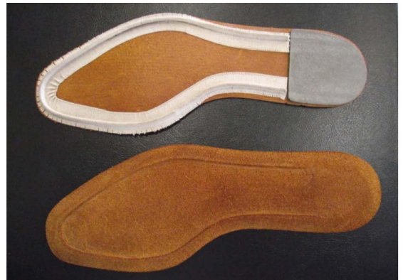
写真8 中底：上段が機械縫い用、下段が手縫い用
