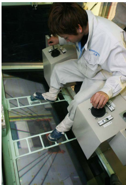
シート下のモニターには 運転席の窓から見える映像が映し出され、 波や風による運転席の揺れを再現することが可能
