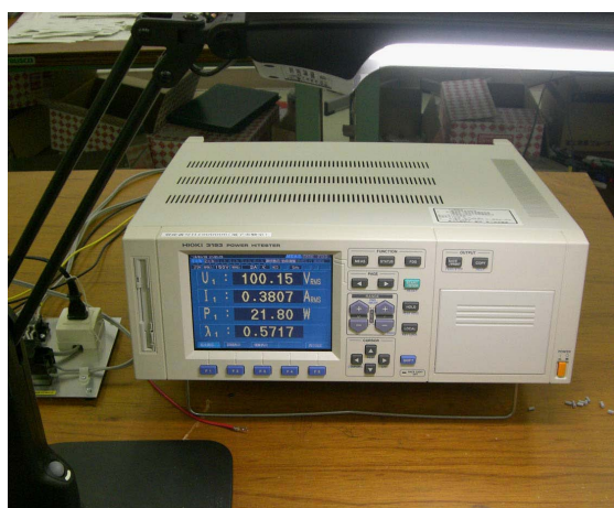
写真10 市販インバータ蛍光灯の力率
