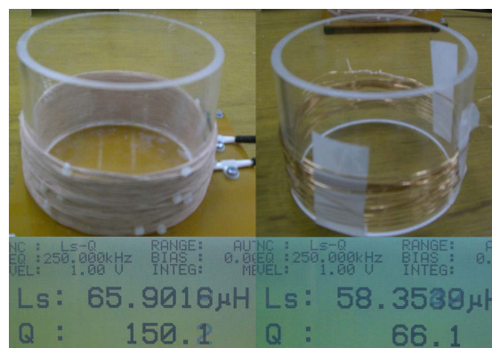
写真12 リッツ線を使ったコイル（左）と単線ウレタン線を使ったコイル（空心）
