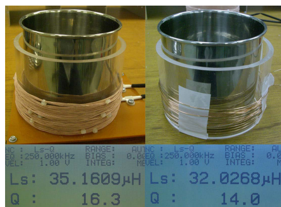
写真13 リッツ線を使ったコイル（左）と単線ウレタン線を使ったコイル（ポット有り）
