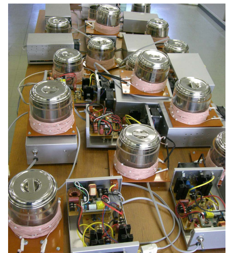
写真4 誘導加熱器の製作物
