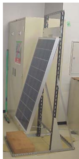
図12 角度と発電量の検証装置
