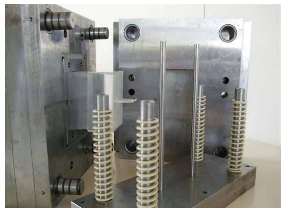
図2 射出成型金型
