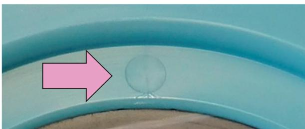
図15 固定側に組み込んだピンの跡
