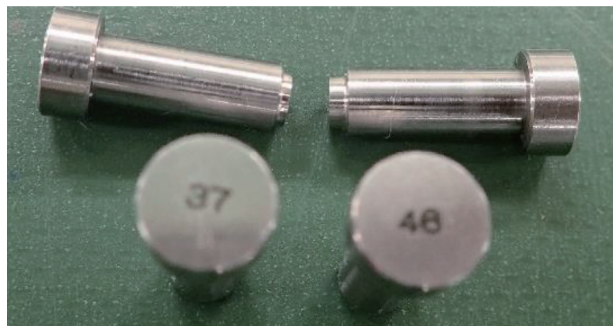
図17 コアピン外観（ \phi 3.7\text{mm} と \phi 4.6\text{mm} ）
