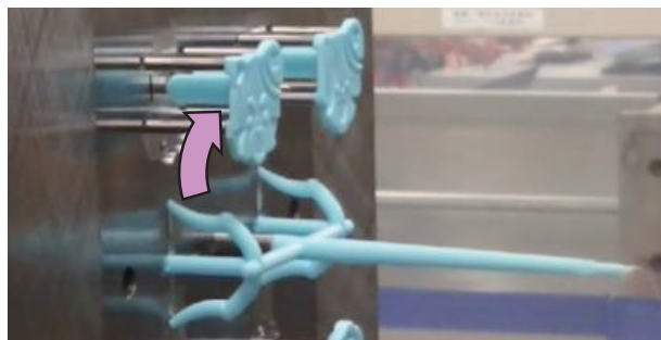
図21 ゲートが離型する直前② (抜き方向左右)
