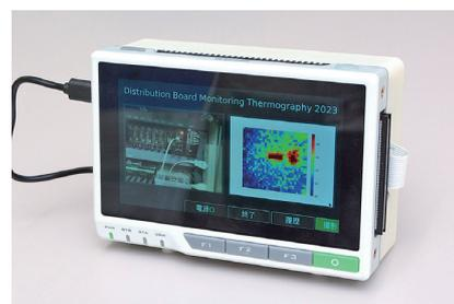
図22 異常温度検知システムの外観
