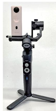
図11 360度カメラを取り付けたジンバル
