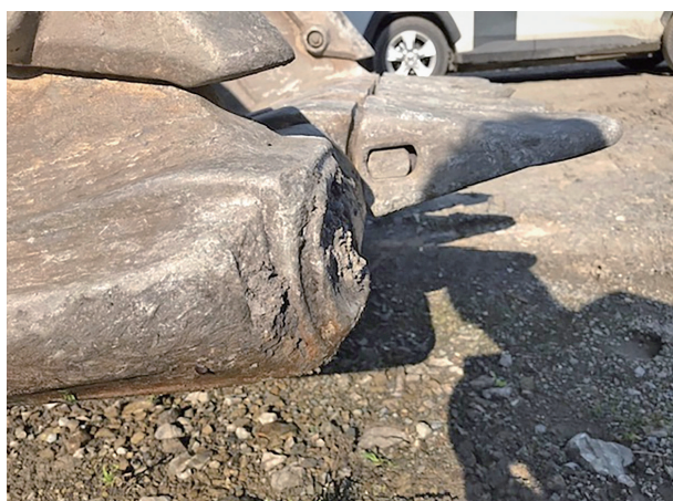
図3 バケットツースアダプタ折損
