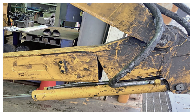
図4 作業機（アーム）亀裂
