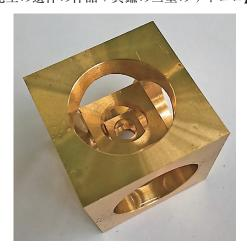
生野先生は真鍮加工の神様。中の立方体は八つの隅を最小0.03mm程度で支えている。素材に切削力の負担をほとんどかけずに削り出しているのだ。さらには制作後10年以上たっているのに表面が変色していない。この表面性状ばかりはどうしてもまねができない。先生は、手研ぎのバイトで真綿のような
