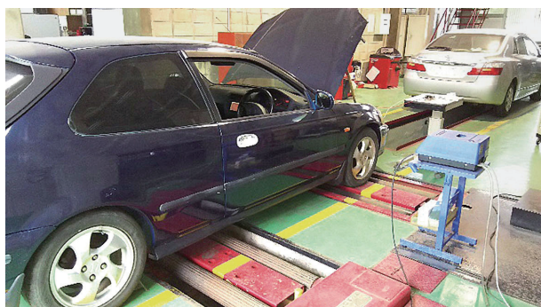
図23 動力性能試験並びに排気ガス測定
