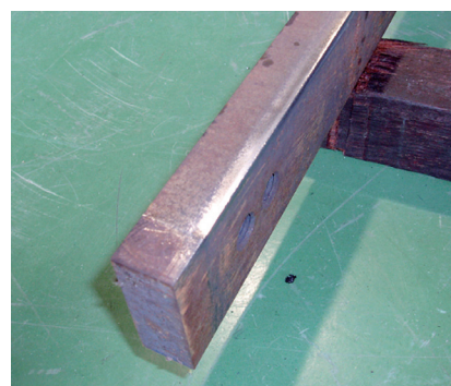
図12 摩耗したブレード
