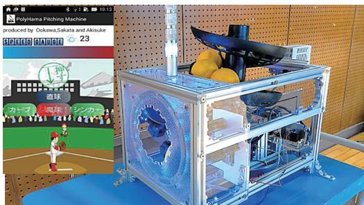
図3 スマホピッチングマシン [平成27年度]
