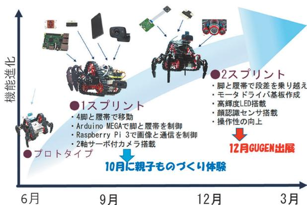
図16 複合移動型ロボットのスプリント
