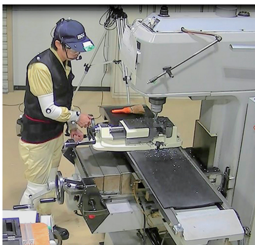
図6 3次元動作分析装置用のマーカー、およびアイマークレコーダを装着した被験者
