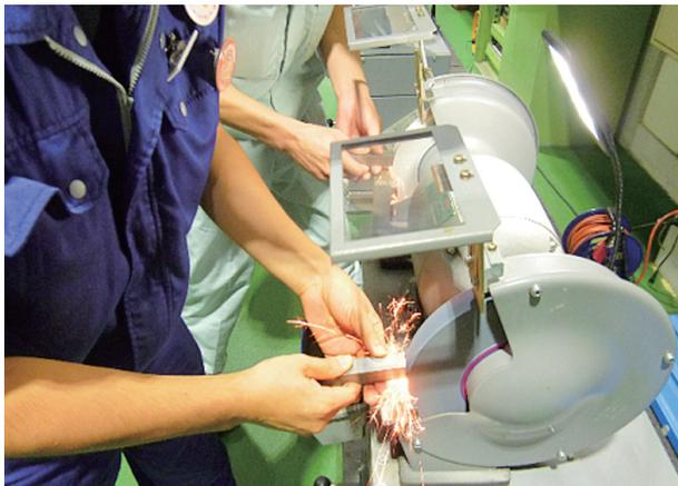
図10 切削工具研削作業の様子
