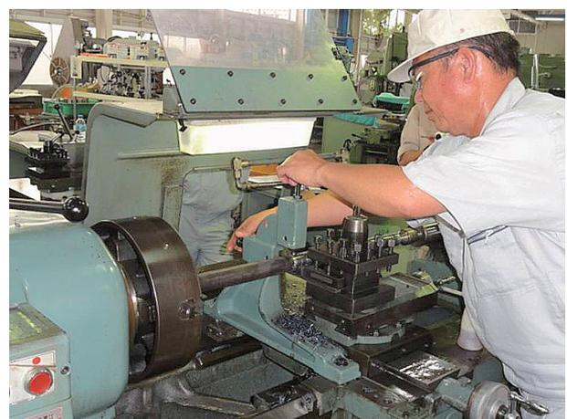
図4 長尺物加工の実技指導の様子
