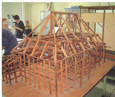
写真3 民家軸組模型製作
