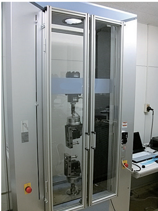
図19 網糸引張り試験機
