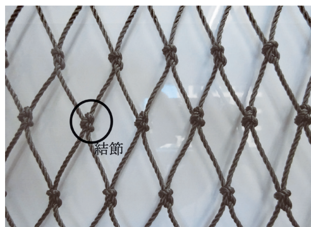
図1-1 一般的な有結節網地
