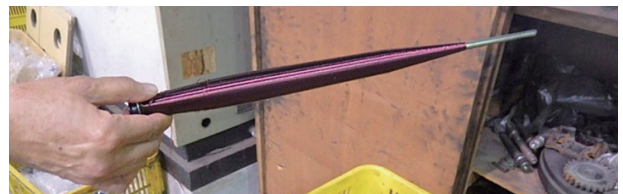
図4 原糸を管に巻いた様子
