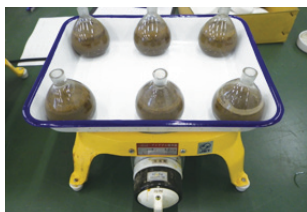
図3 土粒子密度試験器具
