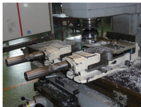
図11 二連バイスによる平面削り
