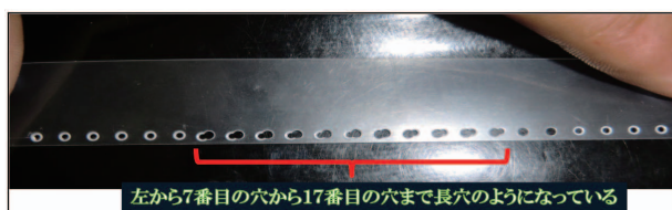
図26 設備停止時のエンボスキャリアテープ
