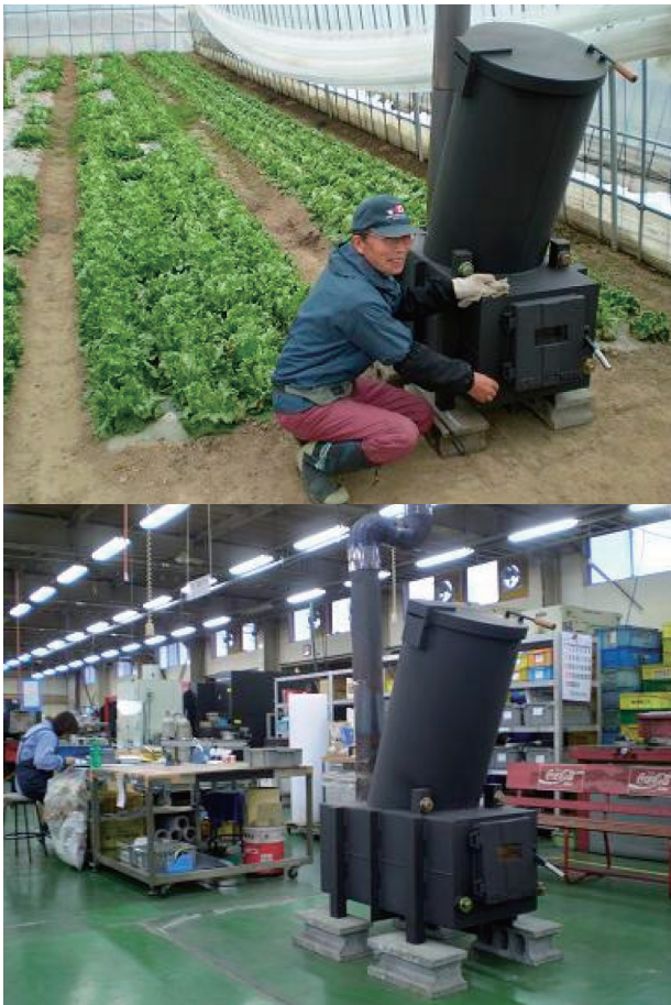
図3 産業用長時間燃焼型薪ストーブの使用例
