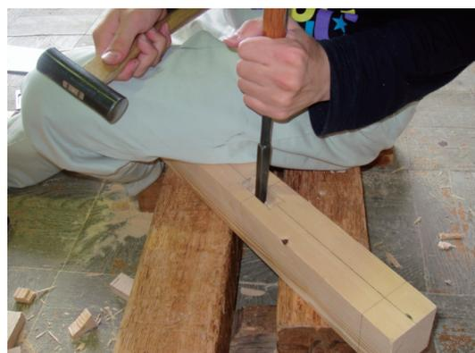
図3 短い材でのほぞ穴掘り作業
