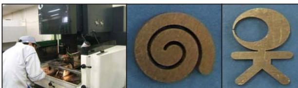
図9 NCワイヤ放電加工機と自由形状の製品
