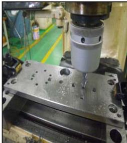
図23 フライス盤加工
