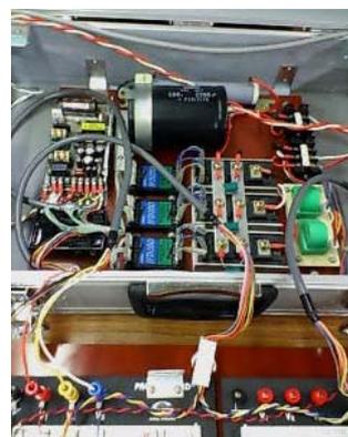
(b) 主回路およびゲート駆動回路
