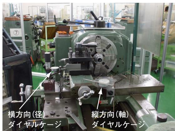
図16 縦、横方向測定用ダイヤル
