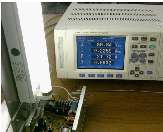
写真11 製作したインバータ蛍光灯の力率
