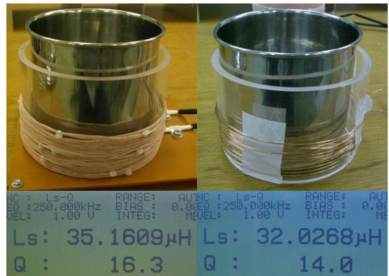
写真13 リッツ線を使ったコイル（左）と単線ウレタン線を使ったコイル（ポット有り）
