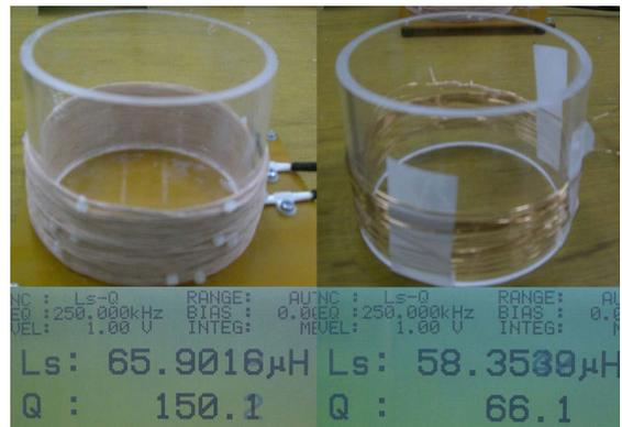
写真12 リッツ線を使ったコイル（左）と単線ウレタン線を使ったコイル（空心）
