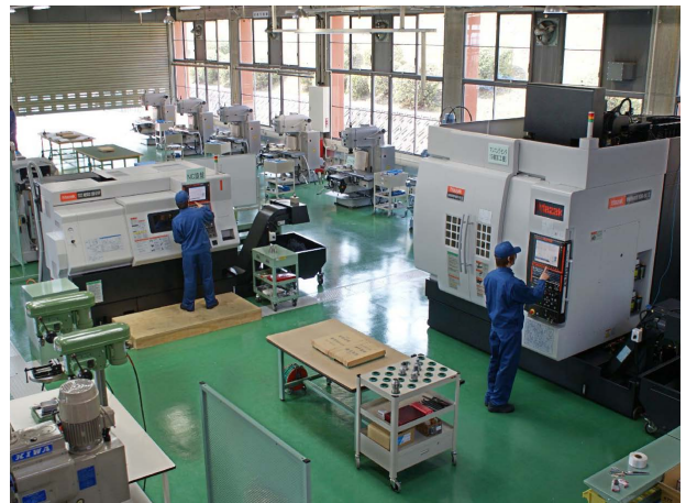
生産技術科実習場 （手前右は5軸MC，左はNC旋盤，奥はフライス盤）
