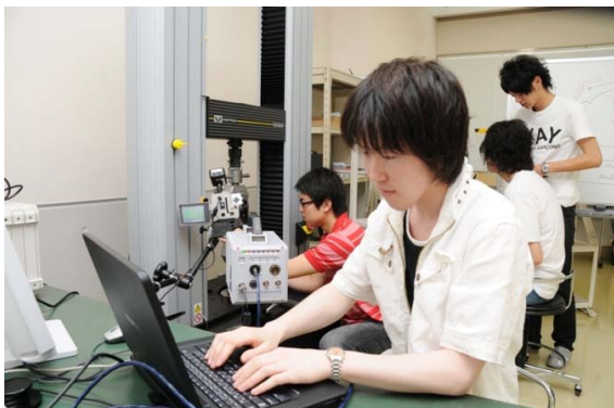
引張試験機、高速度カメラおよび赤外線サーモカメラを用いた伸びによるヤング率の測定実験
