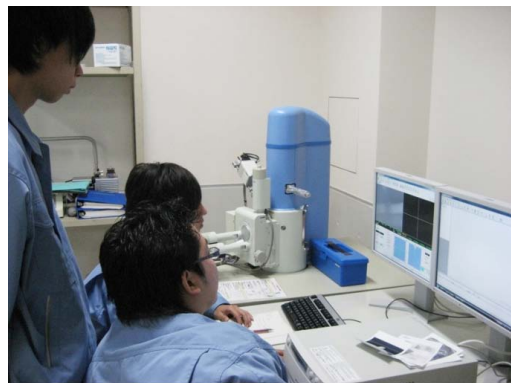
電子顕微鏡による多素材の組織観察実験
