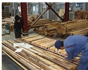
写真22 壁高さの確認
