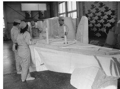
図13 骨組み取り付け作業
