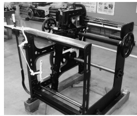
たて糸切断動停止機構 （原寸モデル）
