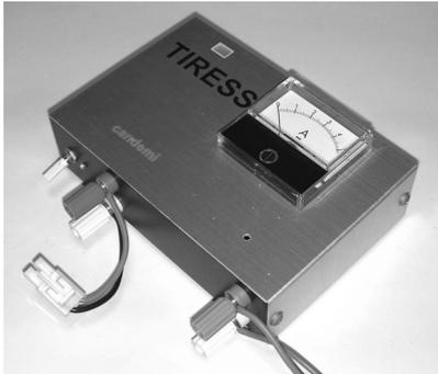
図9 スイッチと電流計をつけたスイッチBOX
