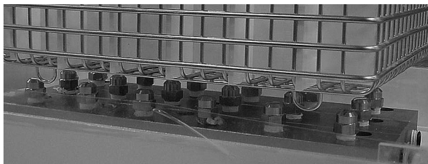
図5 洗浄用ジェットノズル部
