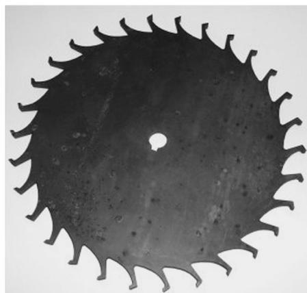
図9 ワイヤカット放電加工による形状(ガンギ車)
