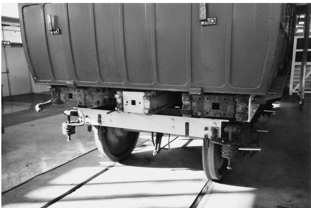
写真4 展望客車の木製台枠端部とボギー式台車の端部
