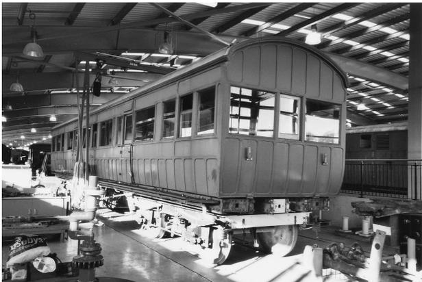
写真3 修復中の木製4輪ボギー式展望客車
