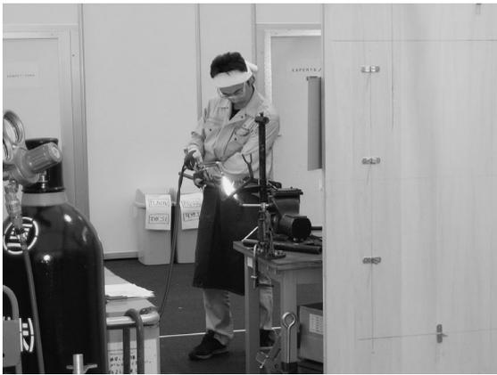
写真8 「配管」のガス溶接作業に取り組む遠間潔寿選手
